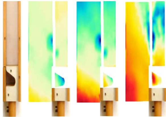
Obrázek 5. Změny hustoty vzduchu vně a uvnitř otevřené průhledné varhanní píšťaly (buzené plynem CO 2 ) na počátku nasazení tónu
