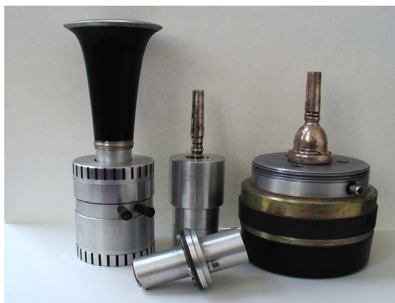
② Budiče pro diagnostiku dechových nástrojů (realizace HAMU 1-4, FEL ČVUT 2-3)
