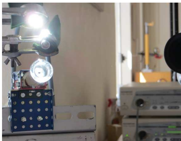
Obr.3: Příklad osvětlení nátrubku světlovodným kabelem
