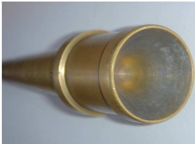
Obr. 2 Ladicí kužel používaný pro zúžení nohy kovových píšťal
