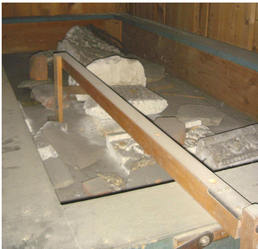
Obr. 1 Zátěž na zásobním měchu varhan
