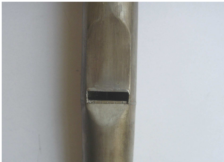
Obr. 2 Labium barokní kovové píšťaly
