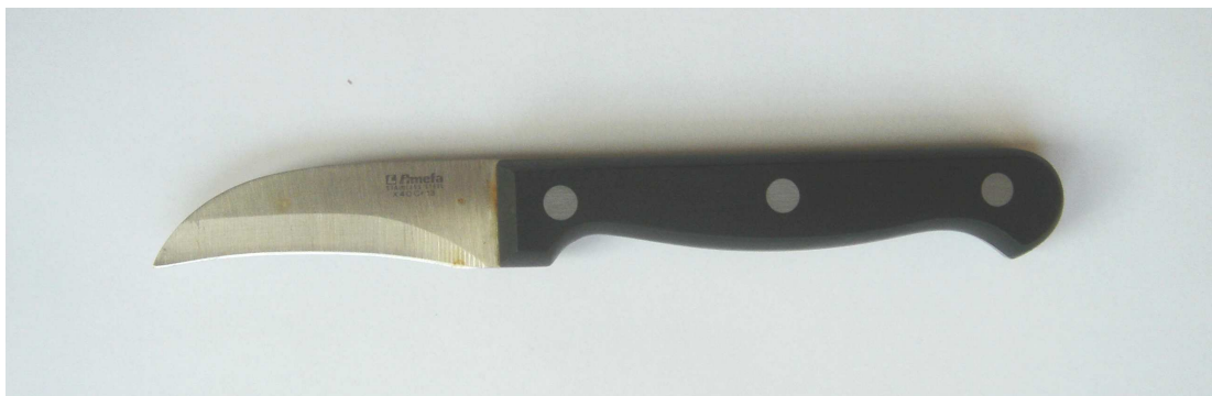
Obr. 2 Nůž použitý při zvýšení výšky labia píšťaly
