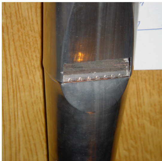
Obr. 3 Snížení rtu píšťaly (vlevo ... vyříznutý stav, vpravo ... po doplnění a zapilování)
