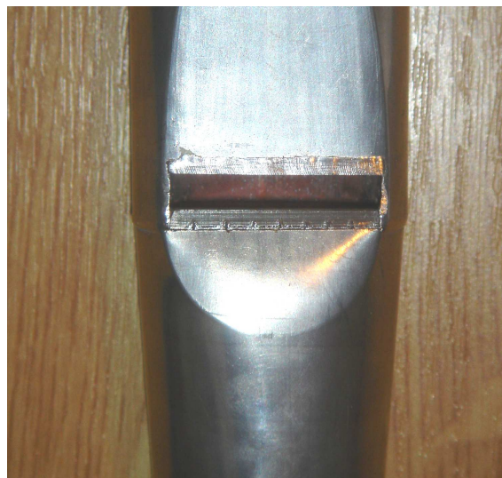
Obr. 3 Snížení rtu píšťaly (vlevo ... vyříznutý stav, vpravo ... po doplnění a zapilování)
