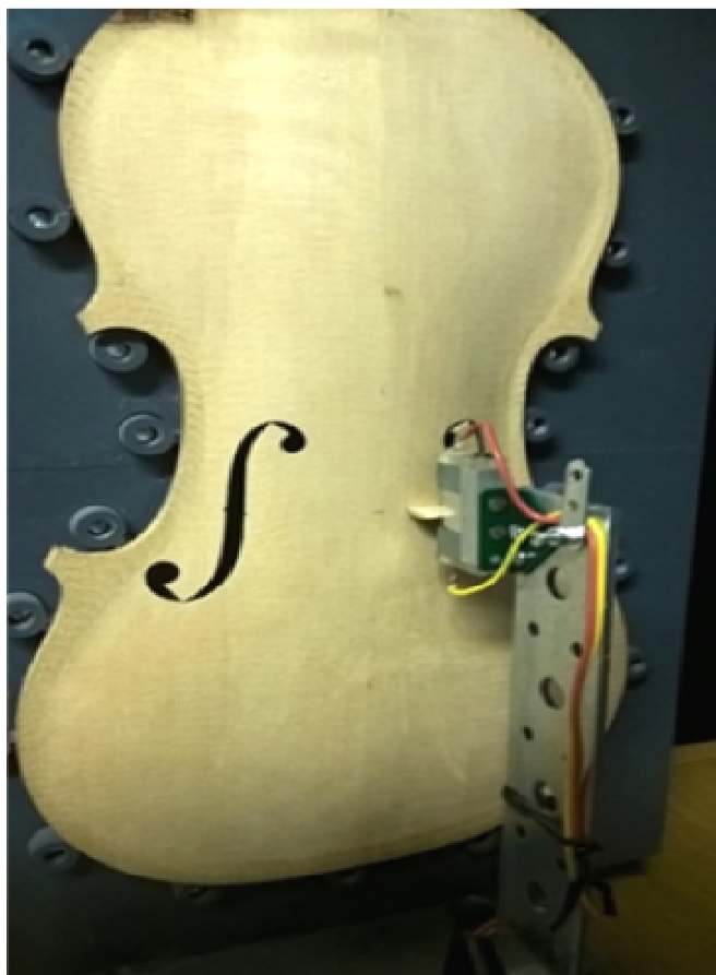
Obr. 10 Detail funkčního vzorku měřicího přípravku s přilepenou horní deskou při umělém buzení vibrací desky elektromechanickým budičem [3] při bezkontaktním snímání výchylek povrchu desky pomocí laserového interferometru [4].
