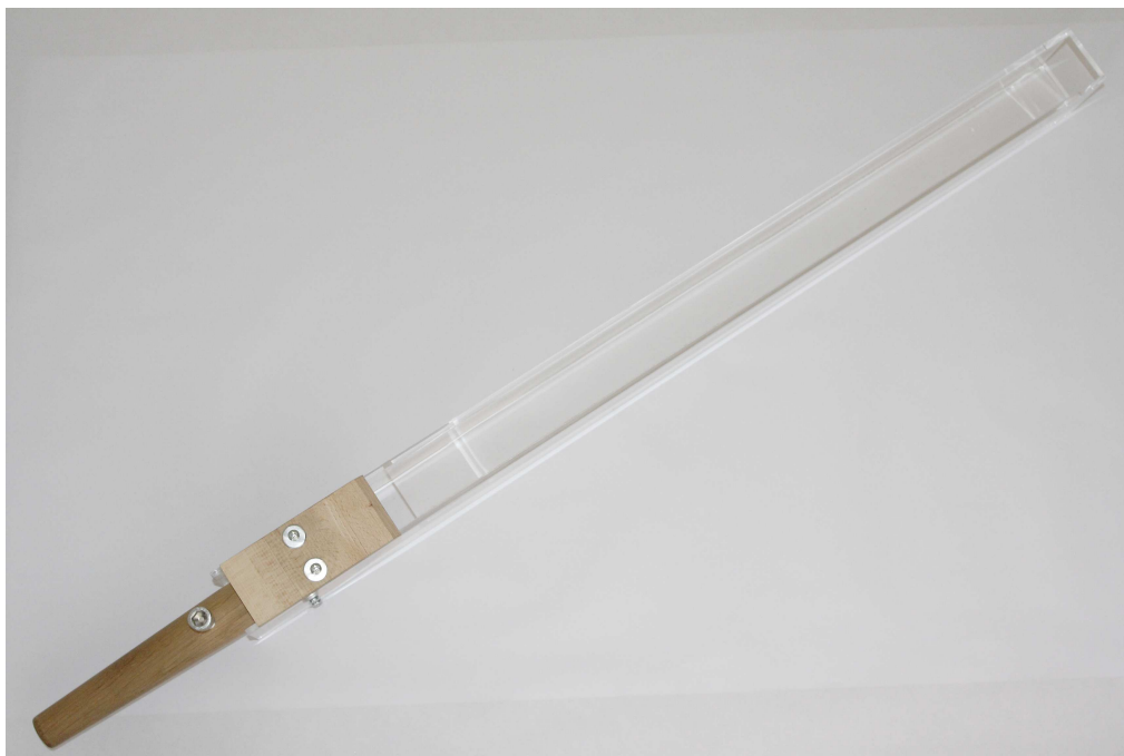
Obr. 6 ... a čelní (dole) pohled na realizovaný funkční vzorek průhledné varhanní píšťaly
