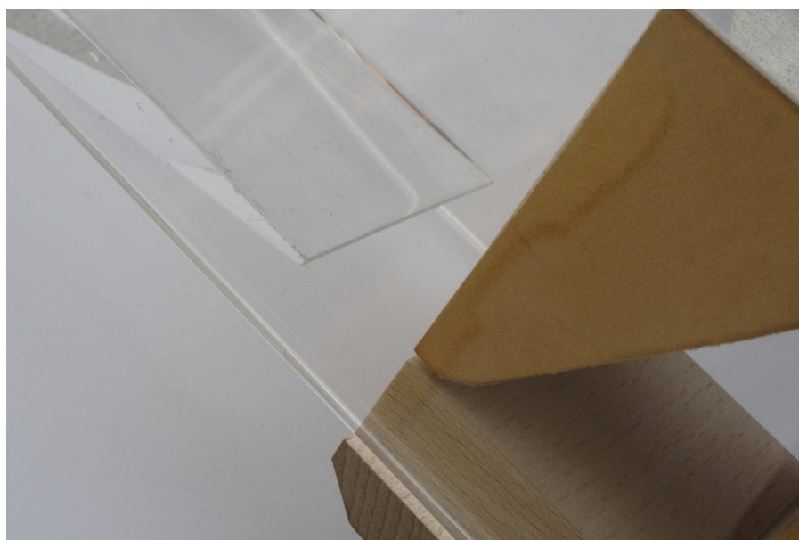
Obr. 7 Viditelná optická rozhraní u průhledné varhanní píšťaly s konstrukčním řešením jako u běžné dřevěné varhanní píšťaly ( ... ) a u funkčního vzorku (dole)
